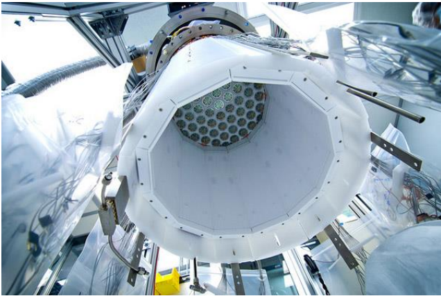
Рис. 1. Рабочая емкость детектора LUX, которая будет заполнена жидким ксеноном. Изображение с сайта luxdarkmatter.org
